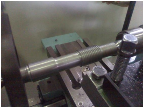
Figura 9-27 - Alargando o canal da rosca - retirada de material nas laterais do filete.
