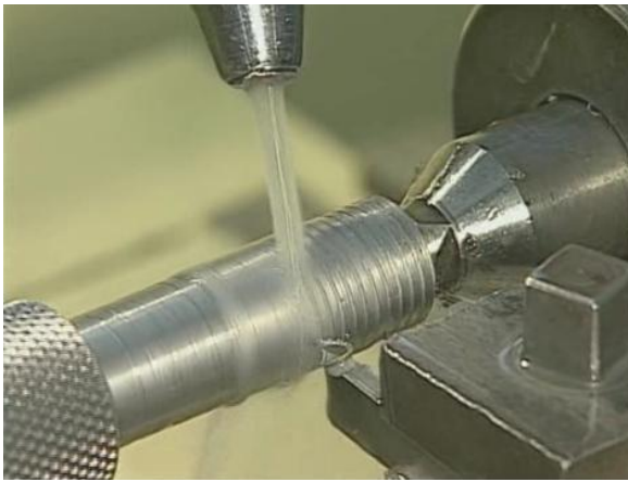
Figura 7-27 – Início do processo de rosqueamento.
