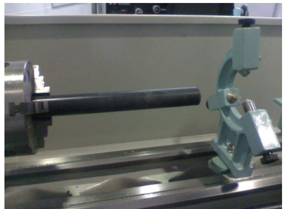
Figura 2-26 – Fixação da peça na placa e colocação da luneta no barramento do torno mecânico.
