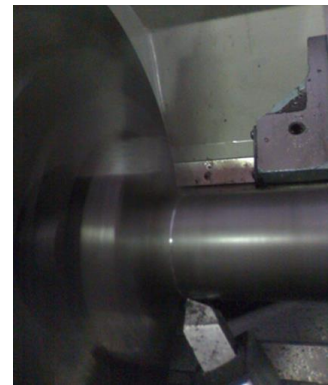
Figura 6-23 – Executando a marcação de referência.
