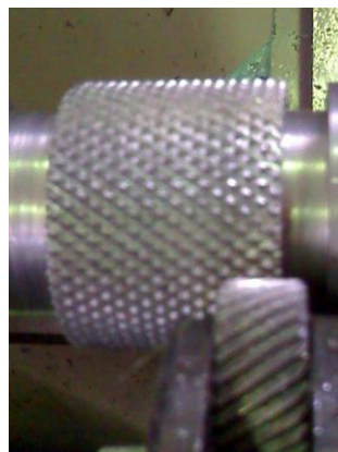
Figura 12-24 – Finalização da operação de recartilhar.
