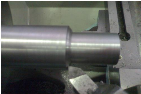
Figura 11-23 – Desbaste das faces perpendiculares com a ferramenta de facear.
