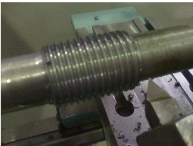
Figura 11-27 – Rosca em fase de execução.
