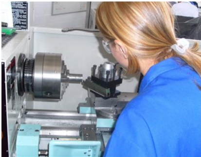
Figura 1-22.1 – Torneamento de superfície cilíndrica externa.
