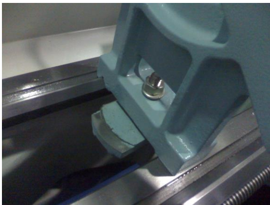
Figura 1-26 – Detalhe da base de aperto da luneta fixa, presa ao barramento do torno mecânico.
