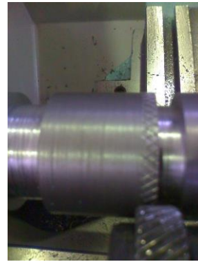
Figura 9-24 – Formação dos canais cruzados.
