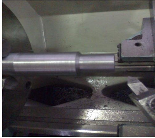
Figura 10-23 – Acabamento do corpo central.
