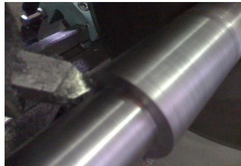
Figura 12-23 – Acabamento das pontas e das faces do rebaixo.
