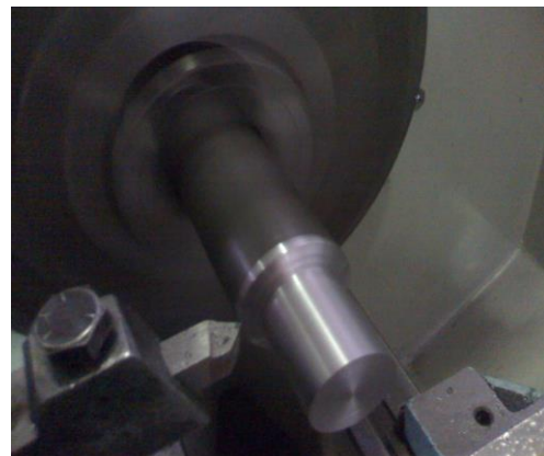
Figura 8-23 – Zerando a ferramenta para iniciar o desbastando o corpo central.
