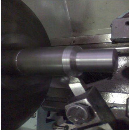
Figura 9-23 – Desbaste do corpo central.
