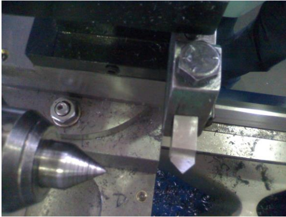
Figura 13-24 – Colocação da ferramenta de chanfrar na altura.
