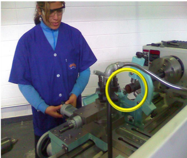
Figura 10-26 – Realização da operação de faceamento.
