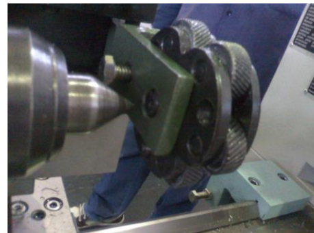
Figura 4-24 – Utilizando a contra ponta para determinar a altura correta.
