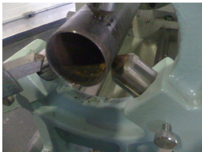
Figura 12-26 – Operação de faceamento concluída.
