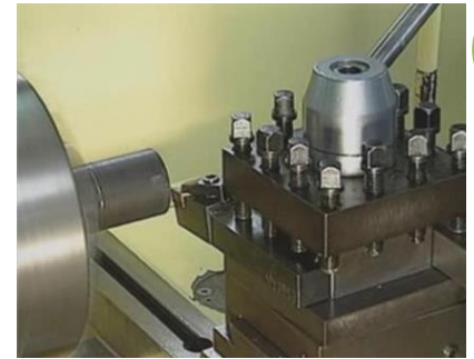
Figura 3-22.1 – Ferramenta pronta para início da operação.
