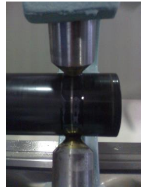
Figura 6-26 – Lubrificação dos contatos, por óleo ou graxa.
