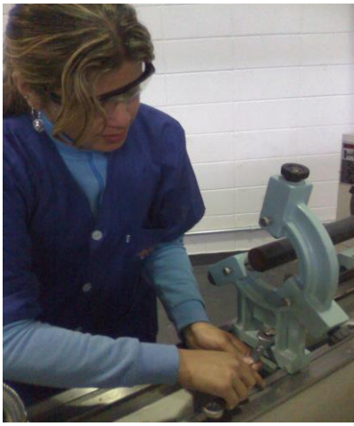
Figura 3-26 – Aperto da luneta no barramento.
