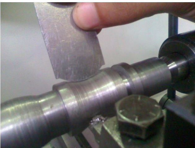
Figura 8-25.1 – Acompanhamento do perfil executado.
