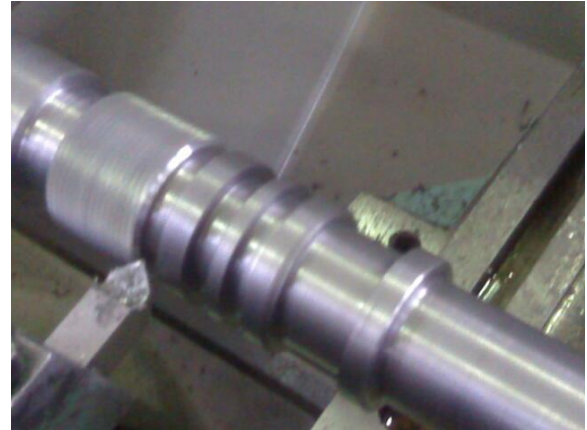
Figura 14-24 – chanfrando o primeiro lado da área recartilhada.
