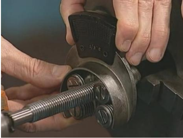
Figura 13-27 - Fazendo a verificação com calibrador de rosca passa não passa.
