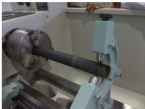
Figura 7-26 – Verificação do aperto e centro da peça.
