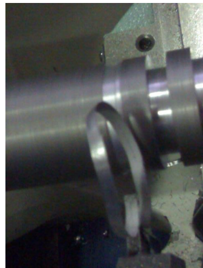
Figura 3-28.2 – Início do alargamento do canal sangrado, lado direito.
