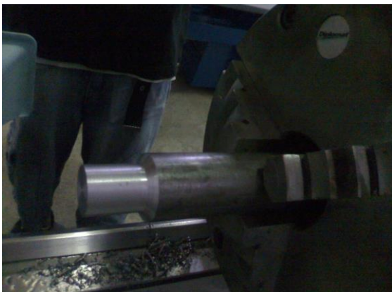
Figura 7-23 – Desbaste do primeiro corpo.
