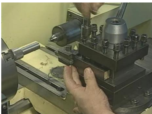
Figura 1-27 – Colocando a ferramenta de roscar na altura.
