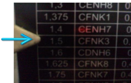
Figura 5-24 – De acordo com o passo da recartilha (1,5mm).
