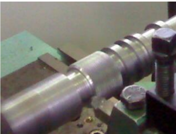
Figura 15-24 – chanfrando o segundo lado da área recartilhada.
